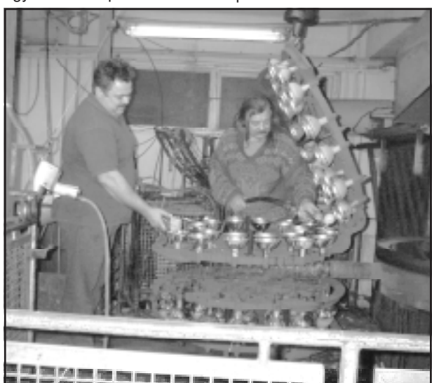
A gyártás egyik legfontosabb mozzanata, a labdaöntés ezen a gépen történik.
